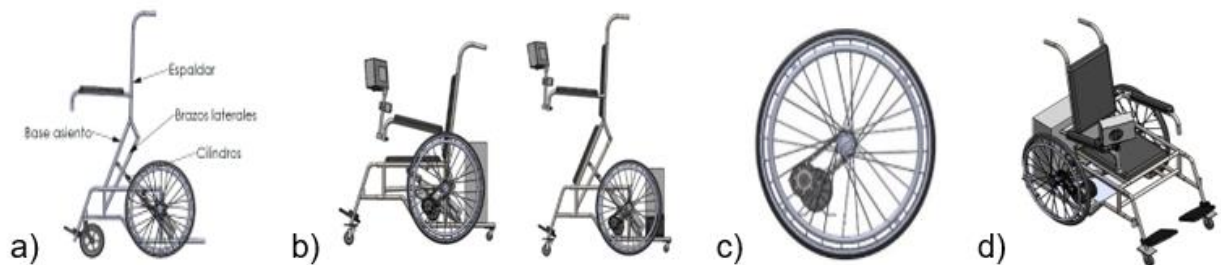
Figura 1. Sistemas componentes del prototipo diseñado.
