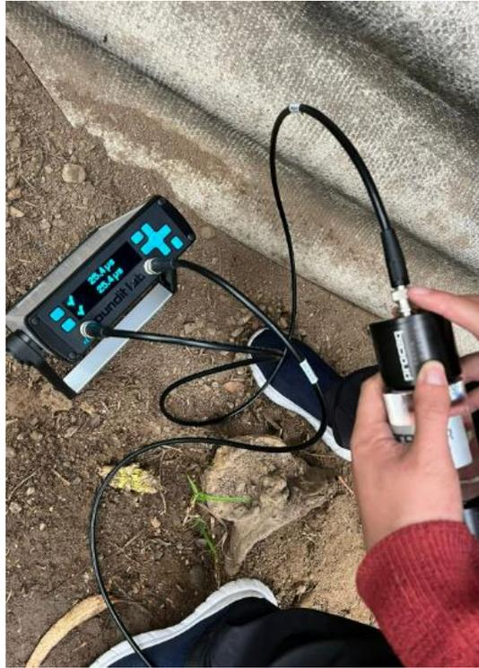
**Figura 16.** calibración del equipo de ultrasonido.
