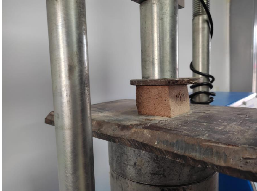
Figura 16. Ensayo a compresión.
